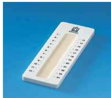
**Remarque:** Maintenir les capillaires remplis à environ 2/3 près de l'extrémité vide. Pour le scellement, plonger l'extrémité vide dans la cire en tournant légèrement le capillaire.
