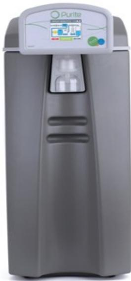
Ce système de production d'eau pure pour laboratoire vous garantit une eau conforme à la norme ISO 3696 de type 3, d'une conductivité inférieur à 30 $\mu$ S/cm
