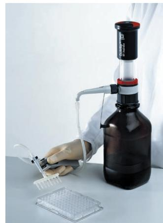
L'aspirateur QuikSip™ avec unité de pipetage à 8 canaux pour l'aspiration de liquides à partir de plaques de microtitration.
