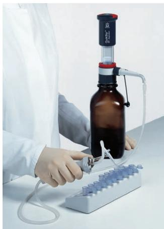
L'aspirateur QuikSip™ avec unité de pipetage unicanal pour l'aspiration de liquide à partir de microtubes, tubes à essais, etc.
